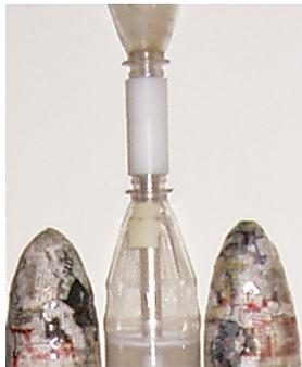
*Crushing-Sleeve im oberen Tank*
